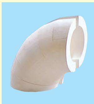
エルボエースは、ケイカルエース・スーパーシリカを切断し、エビ状にブレハブ加工した保温材です。現場で配管の曲り部分を加工しなくてよいため、工期の短縮および加工ロスの低減が図れます。通常のショート・ロングエルボの製作はもちろん、**特殊エルボ**にも対応できます。
