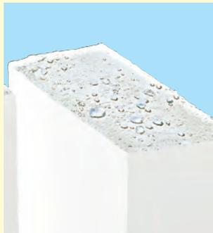
ケイカルエース・スーパーシリカ WPはケイカルエース・スーパーシリカの製造工程で撥水剤を添加した保温材です。工程中で添加しているため切断面にも撥水性があります。特に重油タンクや塔槽類等、使用温度が比較的低い場所では施工中に雨水が降りかかると蒸発し難くなりますが、このように腐食が発生しやすい環境下での施工には特に有効です。
